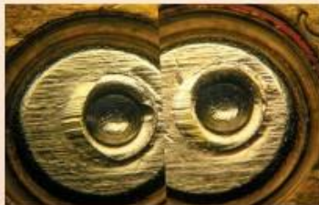
Сопоставление особенностей в следах боя на экспериментальной гильзе, стреляной в представлении патрона, представленном на экспертизу (слева) и на гильзе, представленной на экспертизу (справа)
